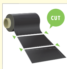
【図-2】従来型プリプレグシートによるCFRPの製造工程
