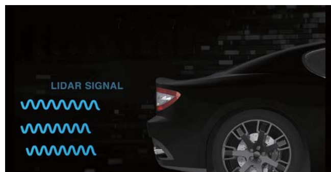
LIDAR信号の近赤外線は、外装塗料のカーボンブラック顔料に吸収され、信号応答性が著しく低下
