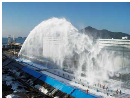
大容量泡放水砲による放射
